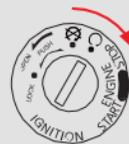
**Posizione ON** Questa posizione viene utilizzata per azionare lo scooter. Installare la chiave e ruotarla in senso orario. In questa posizione si verifica la seguente sequenza:
